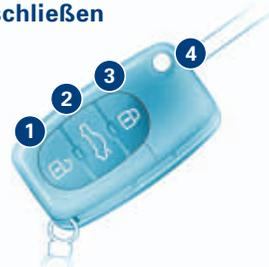
Durch die Zentralverriegelung werden alle Türen, die Heck- und die Tankklappe ver- oder entriegelt. Die Anlage kann über die Fernbedienung oder den Schlüssel betätigt werden.
