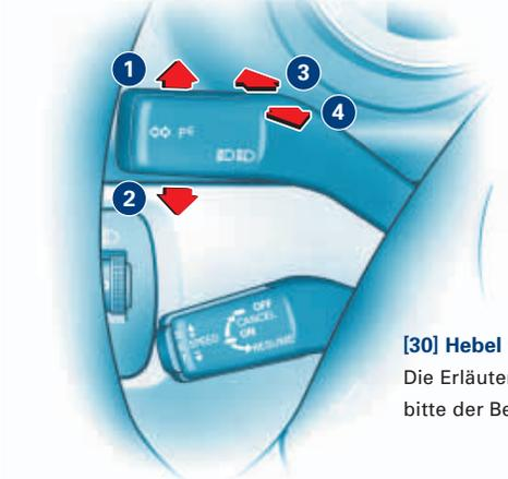
**[30] Hebel für Geschwindigkeits-Regelanlage**
