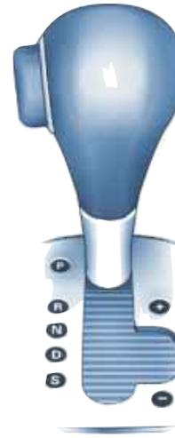
**[24] Wählhebel bei Automatikgetriebe**
