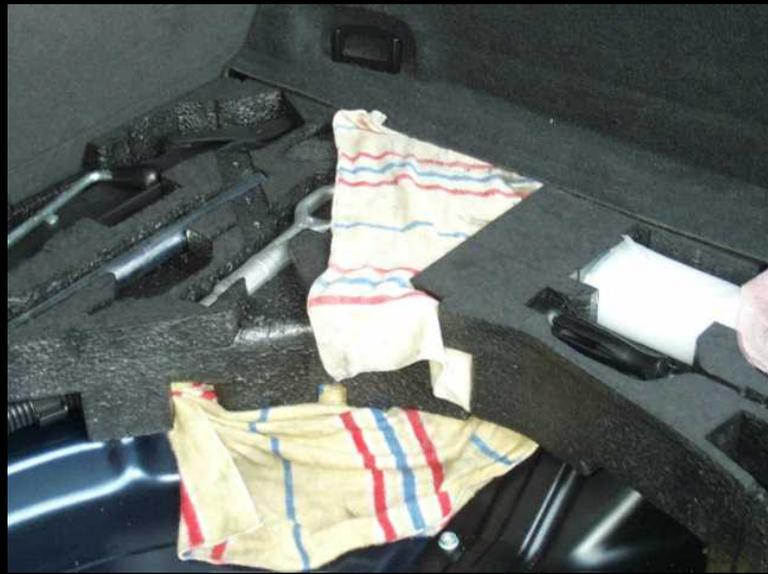
2.) Die Gepäckraumabdeckung. Sie hat eine glatte Unterseite und liegt auf dem Neopolenschaum rechts und auf dem Schraubverschluß des Reserverades in der Mitte auf. Beides kann zu Schubgeräuschen führen. Entkoppeln geht auch wieder mit Staubtuch. Einfach auf Reserverad und Schaumformteil legen.
