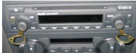
Nun vorsichtig das Radio herausziehen. Das Entriegelungswerkzeug kann durch Drücken der seitlichen Bleche wieder entfernt werden.
