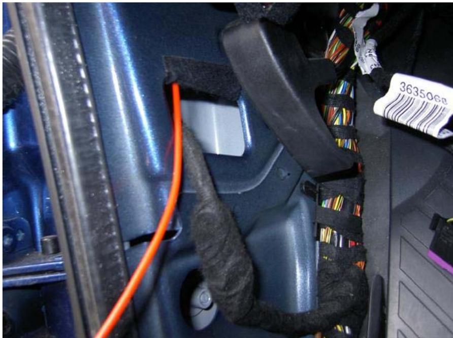
Kabel am Lüftungsstutzen Richtung Mittelkonsole ziehn und fixieren
