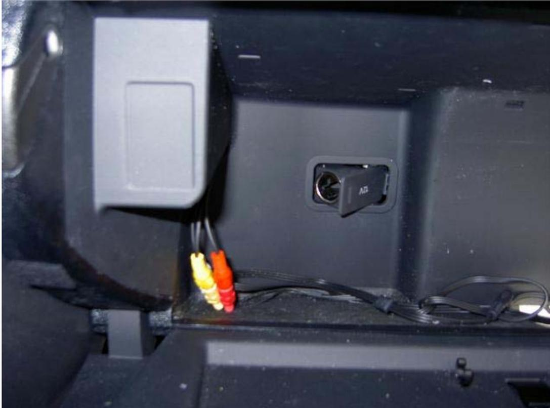
Jetzt erfolgt das wichtige. Das Verlegen und Entkoppeln der Cinchkabel des Interface, des 12Voltstromadapters des DVD-Players, und des AV-Ausgangskabels des DVD-Players. Ich umwickelte sie mit Filzband und kürzte sie dabei auch, durch zusammenlegen. Die Cinchstecker des Interface umklebte ich auch mit Filzband.
