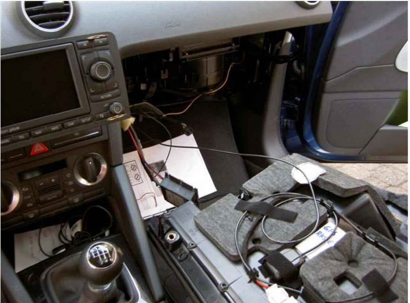
Massekabel an Massepunkt befestigen. Der A3 hat links und rechts an der A-Säule unten Massepunkte zum Abgreifen. Mein Händler klemmte an nem weiteren Punkt am Querträger an
