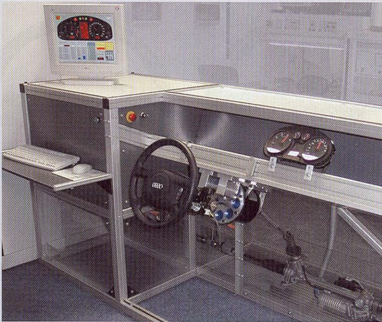
Bild 17: HIL-Simulator für die elektromechanische Lenkung
